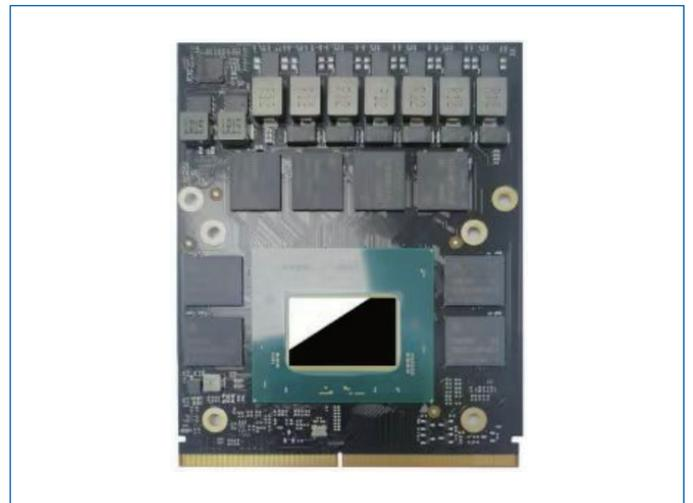
图 4. 基于英特尔锐炫™ A750E 显卡的集和诚 MXM 3.1 Type B 显卡模块
