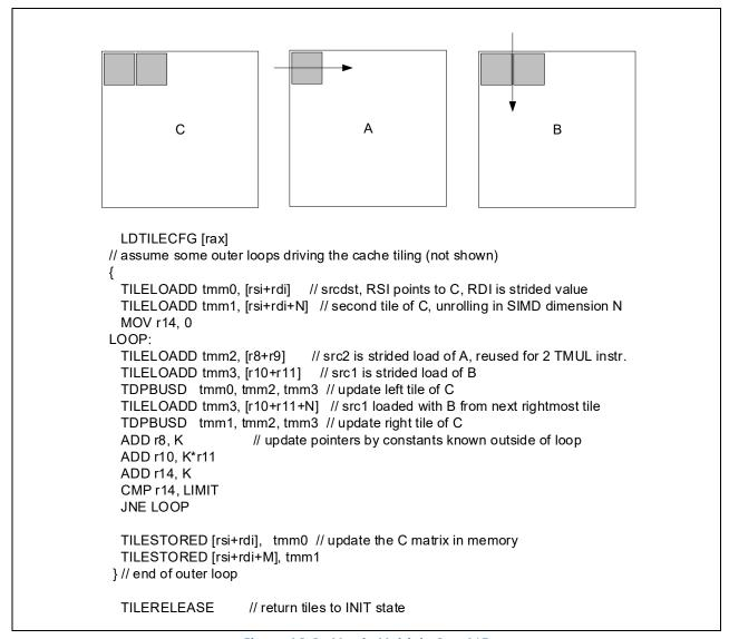
Figure 18-3. Matrix Multiply C+= A\*B
