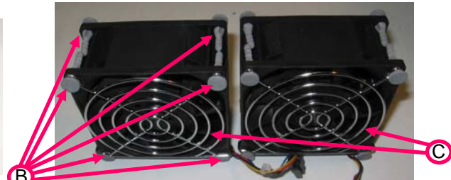
Revised 80mm fan set (FPIO side)
